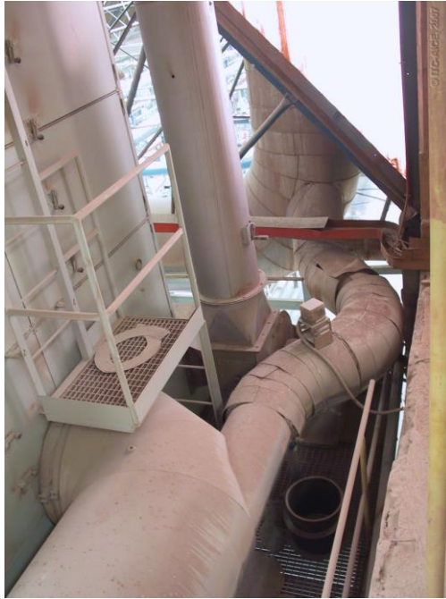
Figura 10. Entrada de gases calientes recuperados en la conducción de recirculación de un secadero vertical.
