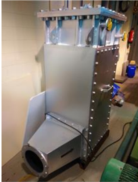
Figura 28. Fotografía del HPHE utilizado para la recuperación de calor de los gases de combustión en un horno piloto (proyecto SMARTREC)
