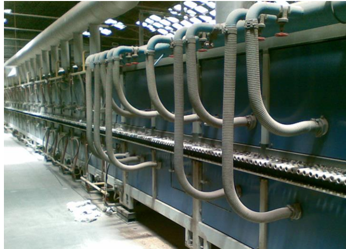
Figura 19. Imagen de la zona de enfriamiento rápido en un horno.
